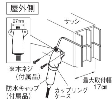
カップリングケースの裏側にある両面テープと木ネジ(付属品)で取り付けができます。フラットケーブルは幅が広い面を浮かないようにサッシに沿わせ、必ず手でまげて取りつけてください。固定が必要な場合は、市販のテープで固定してください。
